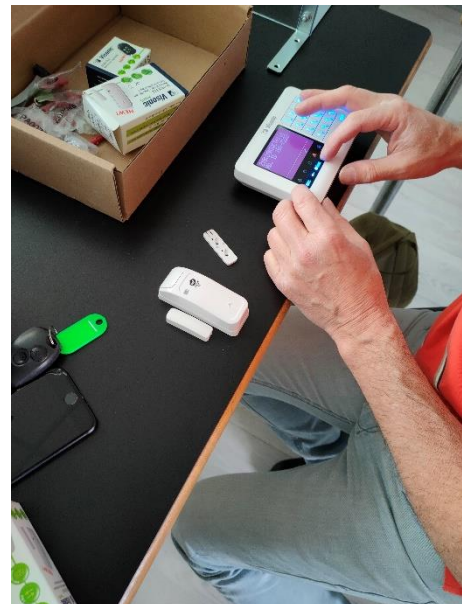
Figure 12 : programmation du contact de porte sur la centrale
